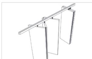
Almacena los módulos **en uno o dos extremos del Tabique Móvil.** Para aquellos espacios que deben compartimentarse de forma lineal, en una sola dirección.
