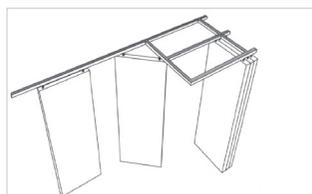
Almacena los módulos **fuera del eje del Tabique Móvil.** Facilitando que el almacenamiento pueda estar tanto dentro como fuera de la sala.
