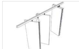
Almacenamiento de los módulos **en uno o los dos extremos del Muro Móvil.** Para aquellos espacios que deben compartimentarse de forma lineal, en una sola dirección.
