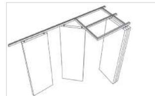
Permite almacenar los módulos **fuera del eje del Muro Móvil.** Facilitando que el almacenamiento pueda estar tanto dentro como fuera de la sala
